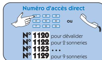
Cette option vous permet de fixer le nombre de sonneries avant le décrochage de la Centrale dans le cadre d'une commande par téléphone.
